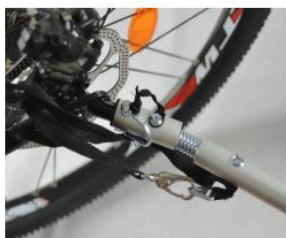
Fest vognkoblingen på sykkelakslingen. Før inn sikkerhetspinnen og fest sikkerhetsstroppen i sykkelrammen som vist på bildet.
