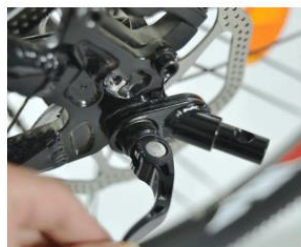
Montera metallkopplingen på hjulramen. För in säkerhetspinnen och fäst säkerhetsremmen i cykelramen.
