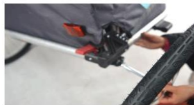
5. Anvend skruen til forhjulet.
