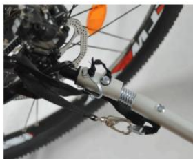
Monter Hitch-beslaget på cykelstellet. Sæt låsesplitten på plads og træk sikkerhedsstroppen gennem den bagerste trekant på cyklens ramme.
