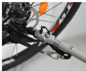
Montera metallkopplingen på hjulramen. För in säkerhetspinnen och fäst säkerhetsremmen i cykelramen.
