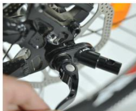
Monter Hitch-beslaget på cykelstellet. Sæt låsesplitten på plads og træk sikkerhedsstroppen gennem den bagerste trekant på cyklens ramme.
