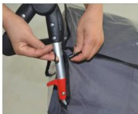
Aseta ja irrota sadesuoja kuvan osoittamalla tavalla.
