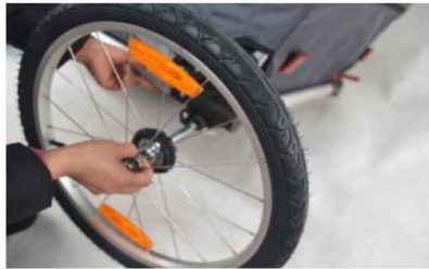
6. Kiinnitä takapyörät ja tarkista samalla, että niiden lukitus toimii.
