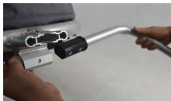
Aseta vetoputki vaunujen C-osaan.
