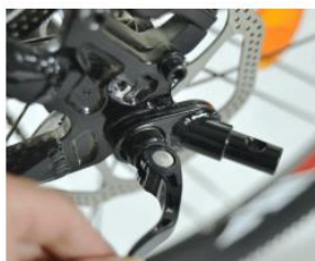
Fest vognkoblingen på sykkelakslingen. Før inn sikkerhetspinnen og fest sikkerhetsstroppen i sykkelrammen som vist på bildet.
