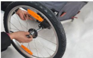
6. Monter baghjulene og sørg for, at de er klikket fast.
