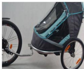
Monter Hitch-beslaget på cykelstellet. Sæt låsesplitten på plads og træk sikkerhedsstroppen gennem den bagerste trekant på cyklens ramme.
