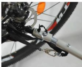
Asenna metallinen kiinnike polkupyörän takarenkaaseen.
