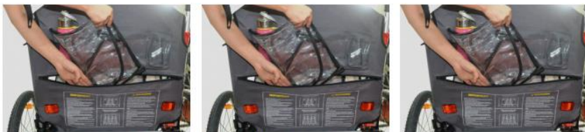
7. Laita sadesuoja vaunun säilytystaskuun kuvan osoittamalla tavalla.
