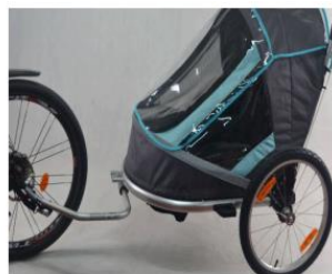
Montera metallkopplingen på hjulramen. För in säkerhetspinnen och fäst säkerhetsremmen i cykelramen.
