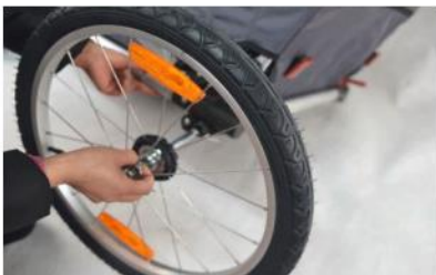
6. Monter bakhjulene og sikre at de sitter skikkelig.
