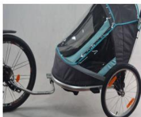
Fest vognkoblingen på sykkelakslingen. Før inn sikkerhetspinnen og fest sikkerhetsstroppen i sykkelrammen som vist på bildet.
