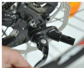
Asenna metallinen kiinnike polkupyörän takarenkaaseen.
